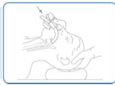
Figura 9: Haga avanzar el dispositivo hacia el interior de la hipofaringe hasta que encuentre resistencia.
